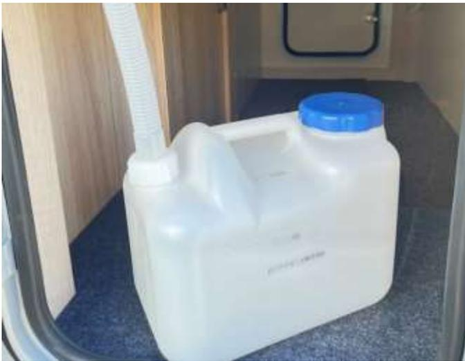
車両備え付けのポリタンクを使って給水タンクに水を入れます。
