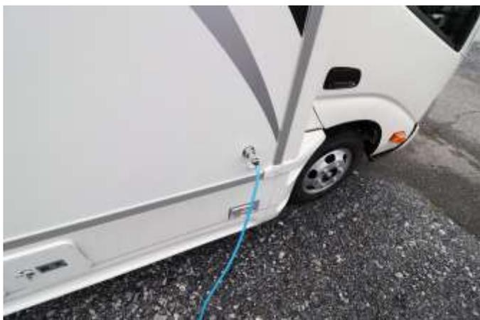
車両に付属のコードを接続して電気を引くと、車内でコンセント、エアコン、電子レンジが使えます。
