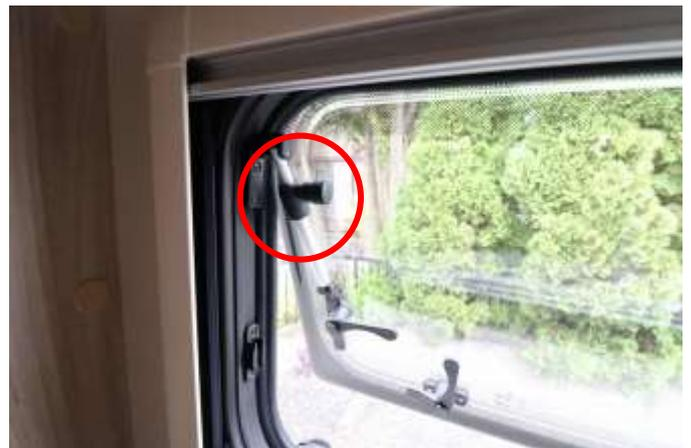
ノブを回して開閉状態を固定します。
