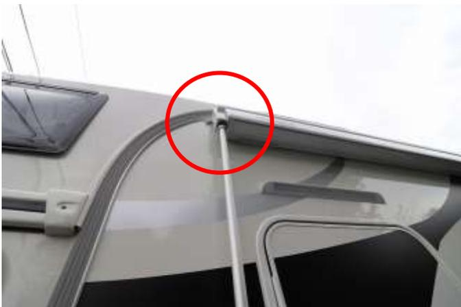
2 段ベッド下にある棒を挿して回すとオーニングが出てきます。
